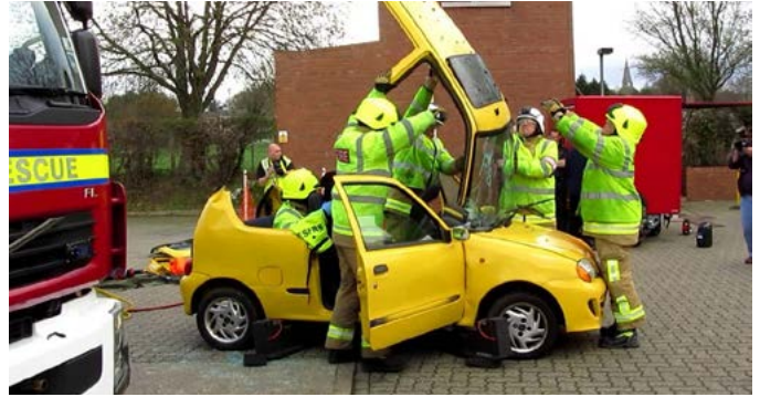
Nếu được thực hiện đúng cách, cắt bỏ nóc xe là một phương án rất nhanh gọn và hiệu quả. Ảnh: Youtube.
